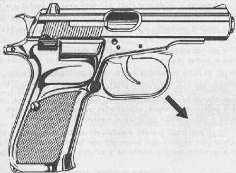
Obr. 13. Vyklopení lučíku pistole
