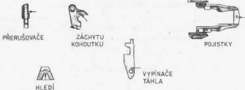
Obr. 2. Umístění značek a rozměrových čísel na 9mm pistolí vz. 82
